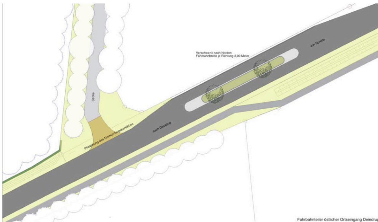
Skizze 1: Fahrbahnteiler östlicher Ortseingang
